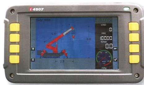
Contrôleur Electronique de Charge (CEC) à écran haute résolution, en couleur
