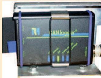
• **Boîte noire (black-box).** Sur demande, il est possible d'installer un dispositif d'enregistrement des données de la plate-forme en fonctionnement.
